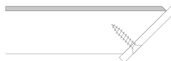
11. Taglio a 45° con bisello & profilo in acciaio inox da 3mm Mitered Cut Chamfered Edge & 3mm Stainless Steel Trim
